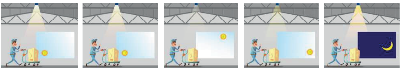
Example of automatic process performed by the sensor / Ejemplo de proceso automático realizado por el sensor
