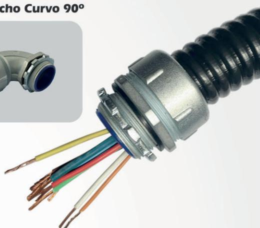
Injetado em liga de zinco, nos diâmetros 1/2", 3/4", 1", 1.1/4", 1.1/2", 2", 2.1/2", 3" e 4", roscas BSP e NPT. Seu bico metálico proporciona continuidade de aterramento e acabamento na extremidade do eletroduto evitando possíveis danos ao cabo. Sua montagem garante a fixação ao eletroduto (**não escapa**). Pode ser instalado em locais com furo passante ou rosqueado diretamente no equipamento.
