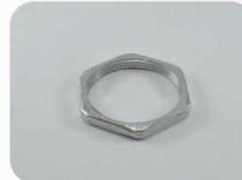
Fabricados em latão ou alumínio, nos diâmetros 3/8", 1/2", 3/4", 1", 1.1/4", 1.1/2", 2", 2.1/2", 3" e 4". Roscas BSP e NPT. Fixado com rosca autotarraxante.
