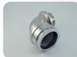
Fabricados em latão, nos diâmetros 3/8", 1/2", 3/4", 1", 1.1/4", 1.1/2", 2", 2.1/2", 3" e 4", roscas BSP e NPT. Sua montagem garante a fixação ao eletroduto (não escapa).
