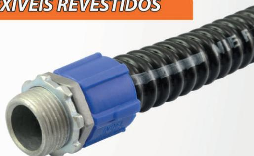
Fabricados em alumínio e nylon, nos diâmetros 1/2", 3/4", 1", 1.1/4", 1.1/2", 2", 2.1/2", 3" e 4", rosca BSP. Proporciona continuidade de aterramento e é fixado por rosca autotarraxante.
